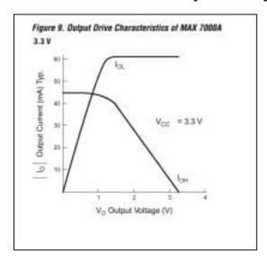
Les courbes ci-contre représentent les caractéristiques courant de sortie en fonction de la tension de sortie d'un circuit logique CMOS (Altera 7000A). La courbe étiquetée «  $I_{\rm OL}$  » est mesurée quand le circuit tente d'imposer un niveau bas en sortie, celle étiquetée «  $I_{\rm OH}$  » est mesurée quand le circuit tente d'imposer un niveau haut en sortie. Le schéma de principe de la mesure est indiqué cidessous :
