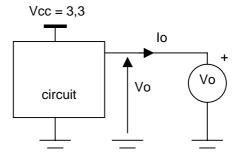
Dans un tel schéma on « force » la tension de sortie et on mesure le courant pour une tension de sortie comprise entre 0 et Vcc. On remarquera que la tension de sortie que l'on impose n'est pas forcément compatible avec les niveaux logiques que tente de fixer le circuit.
