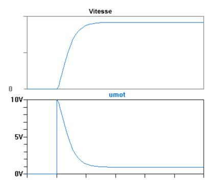
L'amélioration du temps de réponse est obtenu par une commande qui ne reproduit pas l'échelon d'entrée, mais applique au moteur une surtension pour le forcer à démarrer plus vite.
