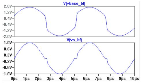
Comme l'amplificateur met un temps fini pour passer d'un transistor à l'autre, une distorsion apparaît sur le signal de sortie, cette distorsion est caractéristique de ce type de montage.
