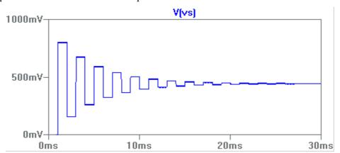
Cette courbe oscillatoire amortie s'obtient sans peine en « tournant dans la boucle » au rythme du retard. Si le gain statique du circuit est augmenté, pour prendre la valeur 1,1 (par exemple), la réponse à l'échelon montre une instabilité franche (attention au changement de l'échelle verticale) :
