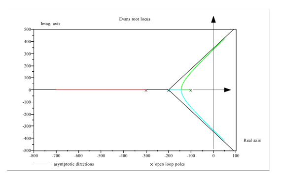
Le même logiciel permet de déterminer le gain en boucle ouverte qui conduit à la limite de stabilité, c'est à dire à deux pôles en boucle fermée imaginaires purs :  $T_{0lim} = 10$ , qui correspond à des pôles situés à  $\pm j332$ , sur l'axe des imaginaires.
