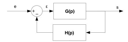
En général G(p) comporte un gain en puissance, dont les paramètres sont souvent mal définis, alors que H(p) est un système de mesure, éventuellement passif, qui peut être réalisé avec une bonne précision. L'exemple typique de cette situation est un schéma d'amplificateur construit avec amplificateur opérationnel : G(p) représente le gain en boucle ouverte de l'amplificateur opérationnel, H(p) est un diviseur passif construit avec des composants qui peuvent être de précision.
