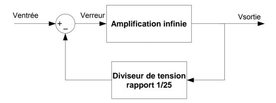
Comme l'amplification est infinie, la tension Verreur est forcément nulle (si le montage est correctement polarisé), d'où :
