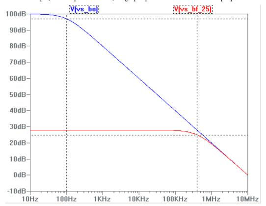
En haute fréquence, le diagramme de Bode de la fonction de transfert en boucle fermée rejoint celui de la fonction de transfert en boucle ouverte (cette propriété est indépendante de l'ordre du système), ce qui conduit, pour un système du premier ordre, à un produit gain\*bande passante identique pour toutes les valeurs de gains en boucle fermée. Ce produit est donc un bon paramètre du système.
